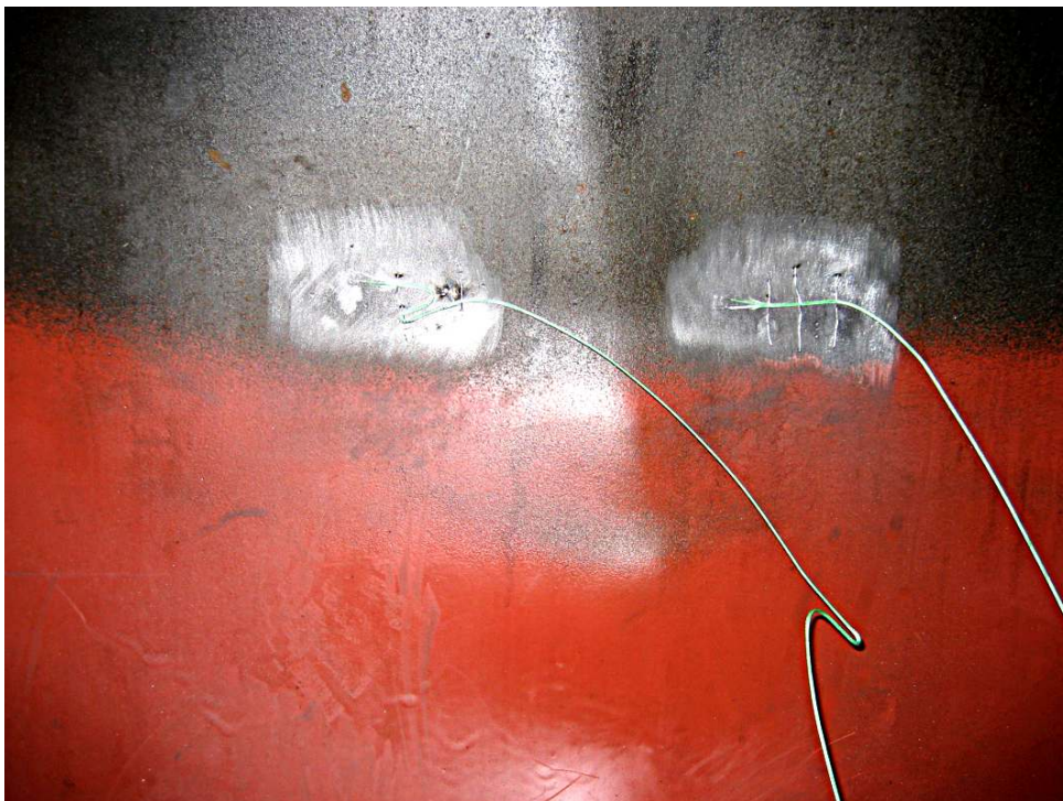
Foto 4 Termoelement för mätning av manteltemperatur
