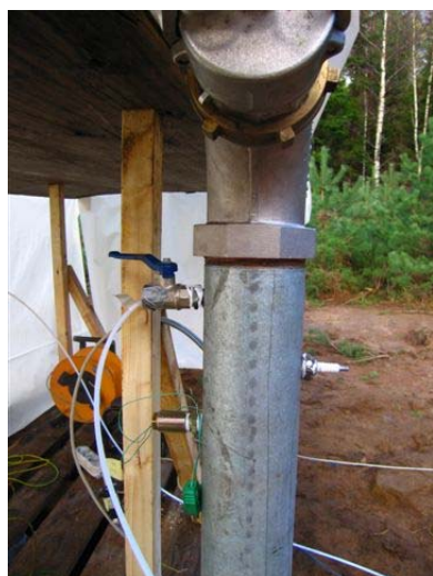
Foto 8 Detaljbild av påfyllningsrör där uttaget för gasanalys sitter strax över tändstiftet. Termoelementen är monterade strax under tändstiftet.
