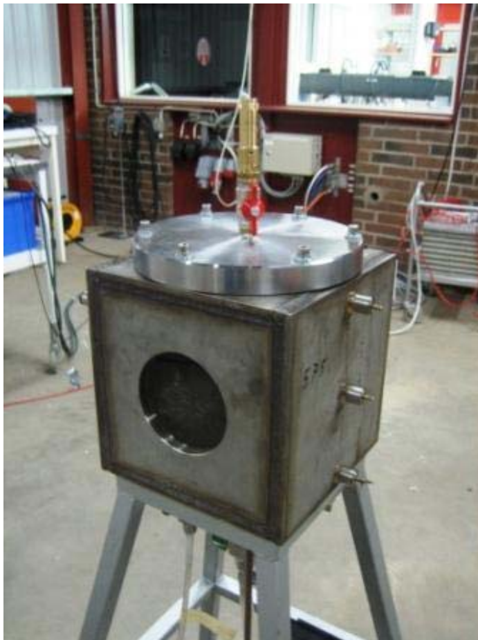
Foto 11 Explosionsbomb för att prova gasblandningens antändbarhet.
